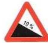
P-16a BAJADA CON FUERTE PENDIENTE
